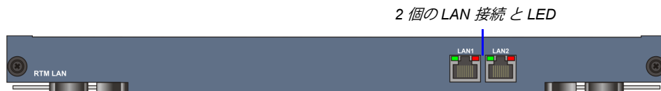
図 1-13 RMX 4000 の RTM LAN リアパネル配置
